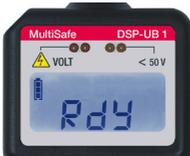
Erscheint **kein „rdY“** ist die Erdverbindung zu prüfen und ggf. zu reinigen, sowie die Prüfspitze und Elektrode zu prüfen. Der Eigentest ist zu wiederholen.
